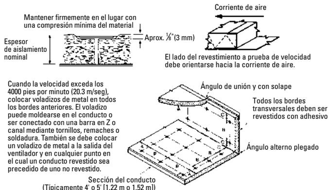
Cuando la velocidad exceda los 4000 pies por minuto (20.3 m/seg), colocar voladizos de metal en todos los bordes anteriores. El voladizo puede moldearse en el conducto o ser conectado con una barra en Z o canal mediante tornillos, remaches o soldadura. También se debe colocar un voladizo de metal a la salida del ventilador y en cualquier punto en el cual un conducto revestido sea precedido de uno no revestido.
