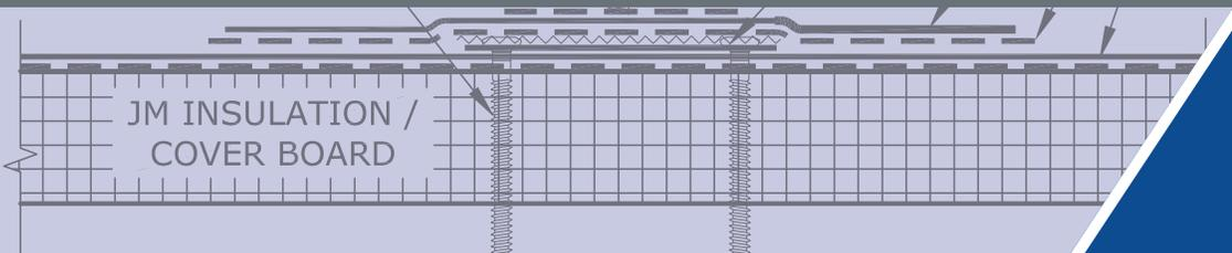
JM ENRGY™ Anchor es una solución de montaje fotovoltaico (FV) ligero y de integración en el techo que consta de una placa de acero revestida y un montante de acero inoxidable y una membrana de cobertura JM.
